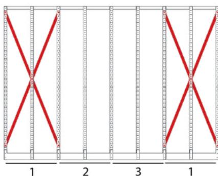
Ogni 3 campate è obbligatorio fissare almeno una crociera di irrigidimento per conferire maggiore stabilità alla struttura. In abbinamento alla crociera è necessario il kit di fissaggio a terra.
